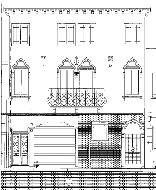
Rilievo fotometrico di una facciata e del muro di sponda sottostante
